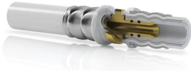
Figure 2 - Raccord à sertir Pexal Brass (laiton) DN14 à 90
