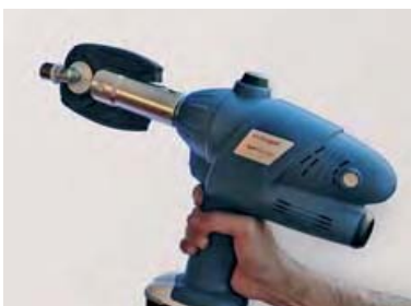
Figure 2 – Réalisation des assemblages DN 12-16-20 avec la pince à sertir manuelle
